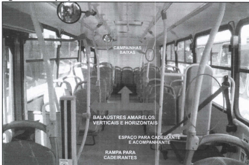
Figura 85: Adaptações Internas facilitam Inclusão
